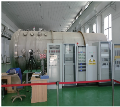
(b)微推进器真空舱模拟标定测试
